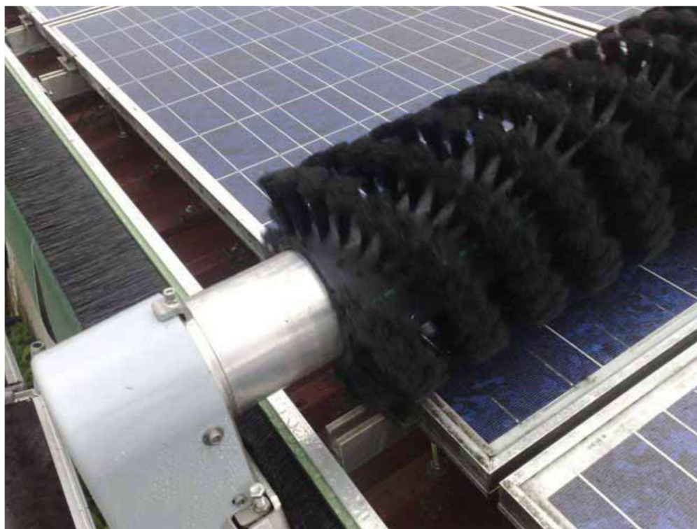
Rysunek 7 Bezwodna technologia czyszczenia paneli fotowoltaicznych
